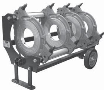
**ЦЕНТРАТОР** (базовый элемент машины) – станина с четырьмя металлическими зажимами для фиксации труб и соединительных деталей. Два из них подвижны (подвижный суппорт) и два неподвижно укреплены на направляющих.
