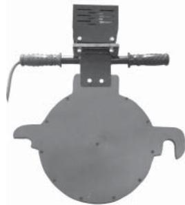
**НАГРЕВАТЕЛЬНЫЙ ЭЛЕМЕНТ (СВАРОЧНОЕ ЗЕРКАЛО)** – служит для нагрева и оплавления свариваемых поверхностей труб и соединительных деталей. Его стороны, контактирующие с свариваемыми поверхностями покрыты тефлоном для предотвращения прилипания полиэтилена. Нагревательный элемент снабжен встроенным термометром.
