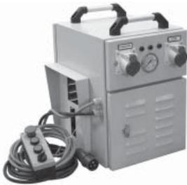
**ГИДРАВЛИЧЕСКИЙ ПРИВОД** – обеспечивает постоянный уровень давления, необходимого для работы сварочной машины с возможностью ее точной регулировки на всех стадиях процесса сварки. Давление автоматически поддерживается во время цикла **ОСТЫВАНИЕ** при выключенном двигателе. В машинах, предназначенных для сварки труб диаметром до 160мм, может быть применен механический привод, где давление регулируется по принципу рычага.
