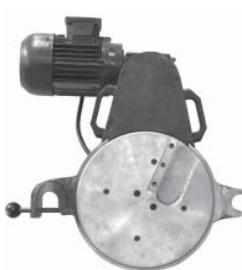
ТОРЦЕВАТЕЛЬ – дисковое устройство, снабженное электродвигателем для механической обработки (торцевания) концов свариваемых труб и соединительных деталей. Торцеватель имеет крепление к направляющим сварочного аппарата для удержания при обработке. При снятии стружки контакт между свариваемыми частями труб и торцевателем обеспечивается давлением подвижных зажимов. Микровыключатель препятствует вращению дисков вне сварочного аппарата.
