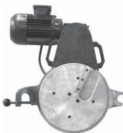
**ТОРЦЕВАТЕЛЬ** – дисковое устройство, снабженное электродвигателем для механической обработки (торцевания) концов свариваемых труб и соединительных деталей. Торцеватель имеет крепление к направляющим сварочного аппарата для удержания при обработке. При снятии стружки контакт между свариваемыми частями труб и торцевателем обеспечивается давлением подвижных зажимов. Микровыключатель препятствует вращению дисков вне сварочного аппарата.
